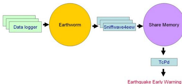
圖二. 利用 Earthworm 系統整合不同觀測網資料後，Sniffwave4eew 程式進行觸發判斷並將相關參數丟入共享記憶體中，由 TcPd 程式進行地震定位及估算規模，輸出預警資訊。
