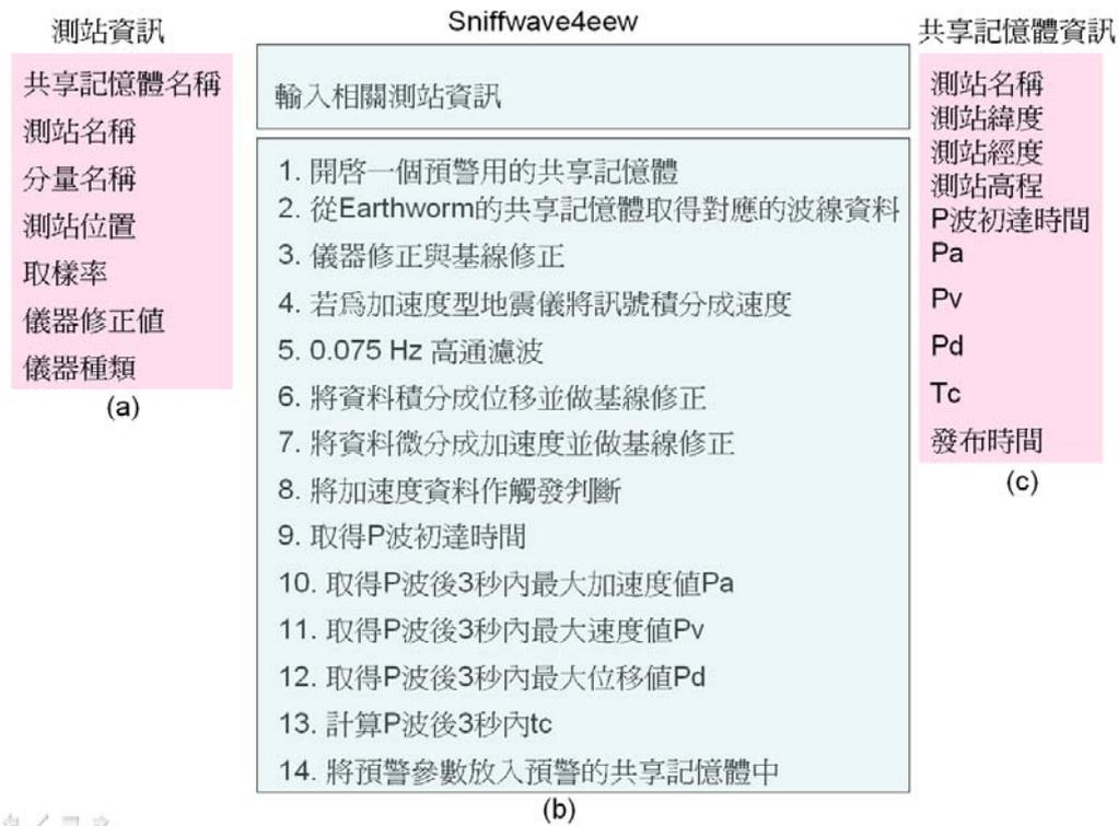
圖四. (a)執行 Sniffwave4eew 程式時前要輸入的測站參數，(b) Sniffwave4eew 程式處理資料的流程，(c) Sniffwave4eew 程式傳入預警用共享記憶體的資訊。
