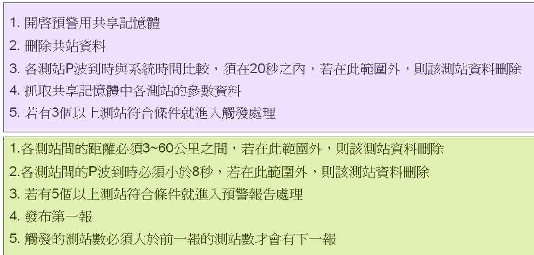
圖五、TcPd 程式之執行流程。
